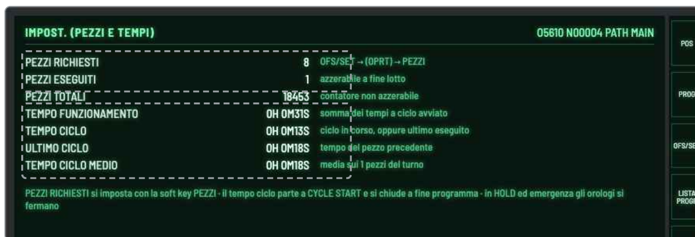
Fig. 27 – Lotto da 8 pezzi in lavorazione continua, primo pezzo chiuso. In verde i contatori: PEZZI RICHIESTI e PEZZI ESEGUITI . In ambra i tempi: funzionamento totale, ciclo in corso (13 s), ultimo ciclo chiuso (18 s) e media del turno.
