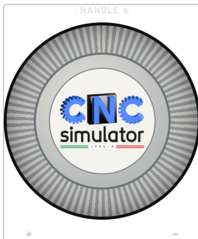
Fig. 9a – Il volantino: + e - indicano il verso di rotazione rispetto alla direzione dell'asse.
