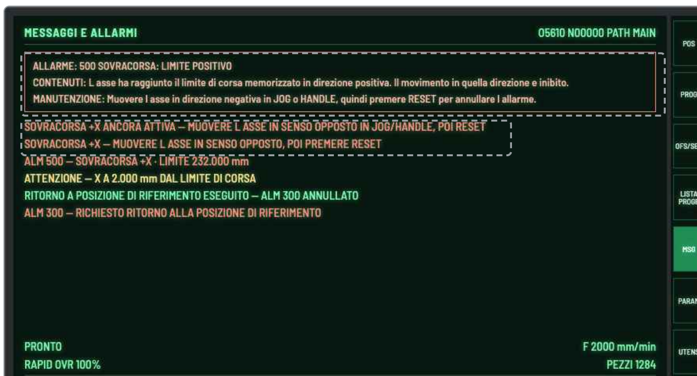
Fig. 24 – Pagina MESSAGGI E ALLARMI dopo una sovracorsa in +X. In rosso il riquadro dell'allarme attivo con CONTENUTI e MANUTENZIONE ; in ambra le due righe che documentano il tentativo di RESET rifiutato. Sotto, nello storico, l'avviso di preavviso a 2 mm dal limite e ALM 500 con il valore del limite raggiunto.
