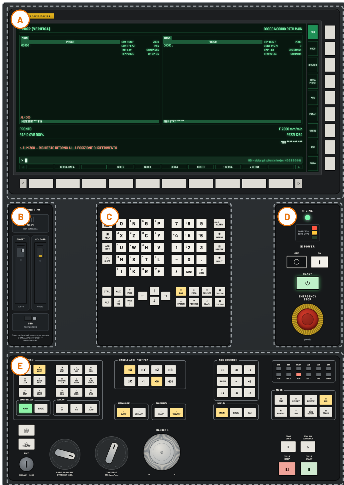
Fig. 1 – Il pannello operatore completo: A schermo LCD con le soft key, B supporti di ingresso/uscita, C tastiera MDI, D alimentazione ed emergenza, E pannello macchina.
